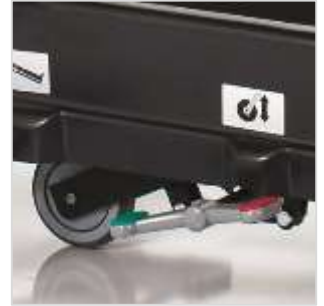
Cinquième roulette escamotable pour une manœuvrabilité parfaite.
