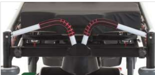
Les poignées de poussée sont pliables et amovibles.
